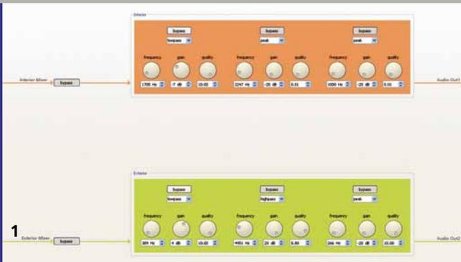
1 *Getrennte Nachverarbeitung der Audiosignale für Innen- und Außenraum über Equalizer und Filteralgorithmen.*
