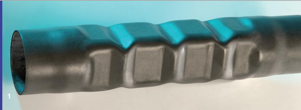
1 Beispiel eines durch Presshärten hergestellten geschlossenen Profils. Im konkreten Fall handelt es sich um die Kombination der Presshärte-technologie mit der Innenhochdruckumformung IHU.
