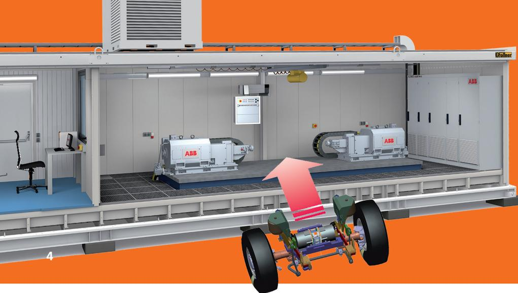
Schutzvorrichtungen. Zur Erreichung einer erhöhten funktionalen Sicherheit wird im Antrieb eine 3H-Topologie umgesetzt, wodurch einzelne Wicklungsstränge abgeschaltet werden können und im Fehlerfall ein Betrieb mit reduzierter Leistung ermöglicht wird.
