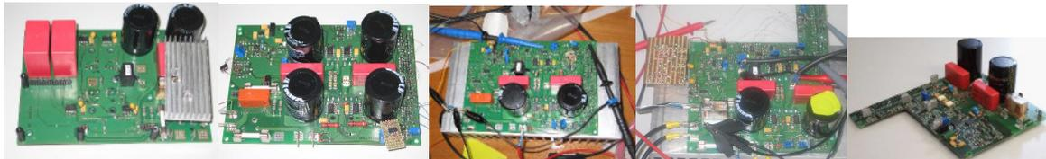
Abbildung 4: Entwicklungsschritte des frequenznachführenden 140kHz-Inverters
