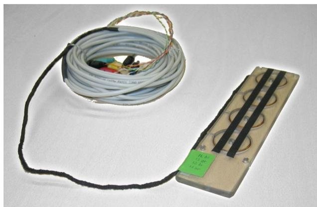
Abbildung 27: Feldspulen zur Bestimmung einer 2D-Ansicht aller z-Komponenten der Feldverteilung im Spulenzwischenraum
