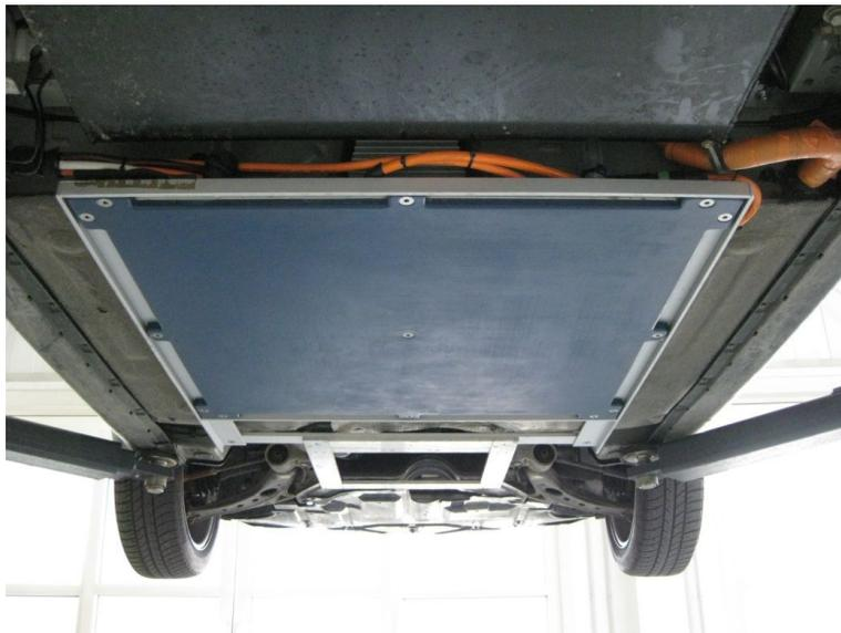
Abbildung 19: Foto des Unterbodens inklusive Sekundärplatte, mit einer Trägerstruktur aus Aluminium fixiert
