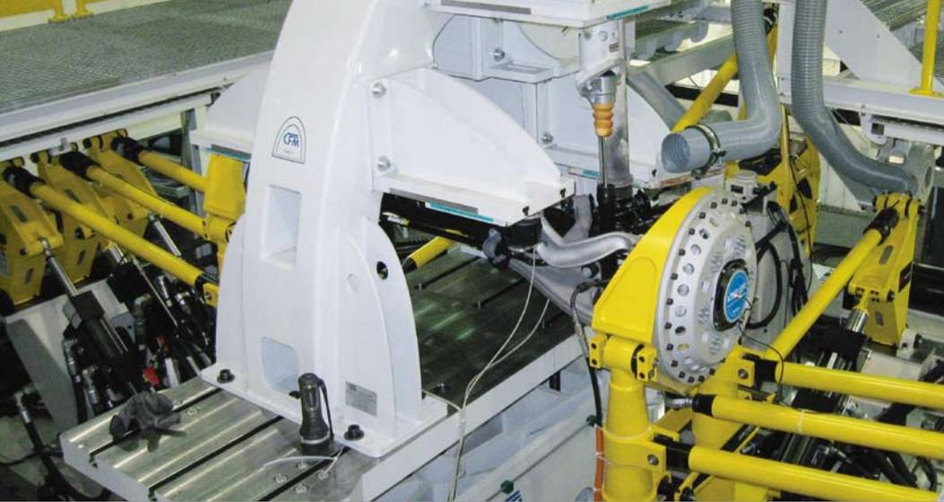
*Prüfstand im Modus Achserprobung: Segment mit Hubtisch und Achsbock.
