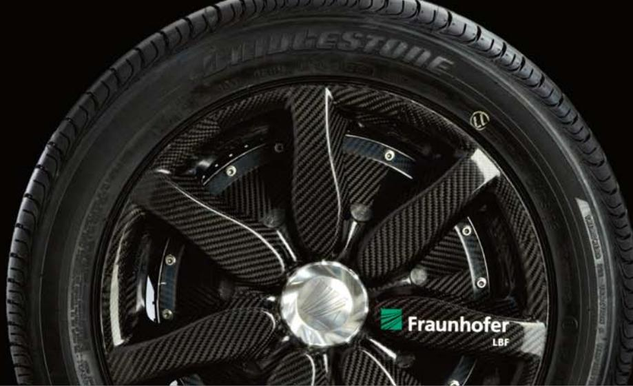
*Kohlenstofffaserverbund (CFK) Rad mit integriertem Elektromotor.
