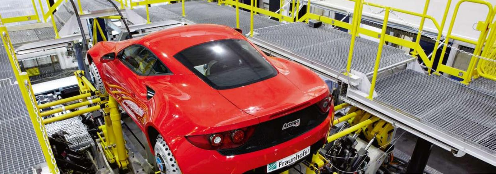
Prüfstand im Modus Ganzfahrzeugprüfung.
