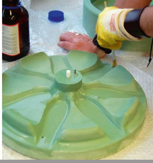
**Bearbeitung der Radformen bei der Fertigung.**
