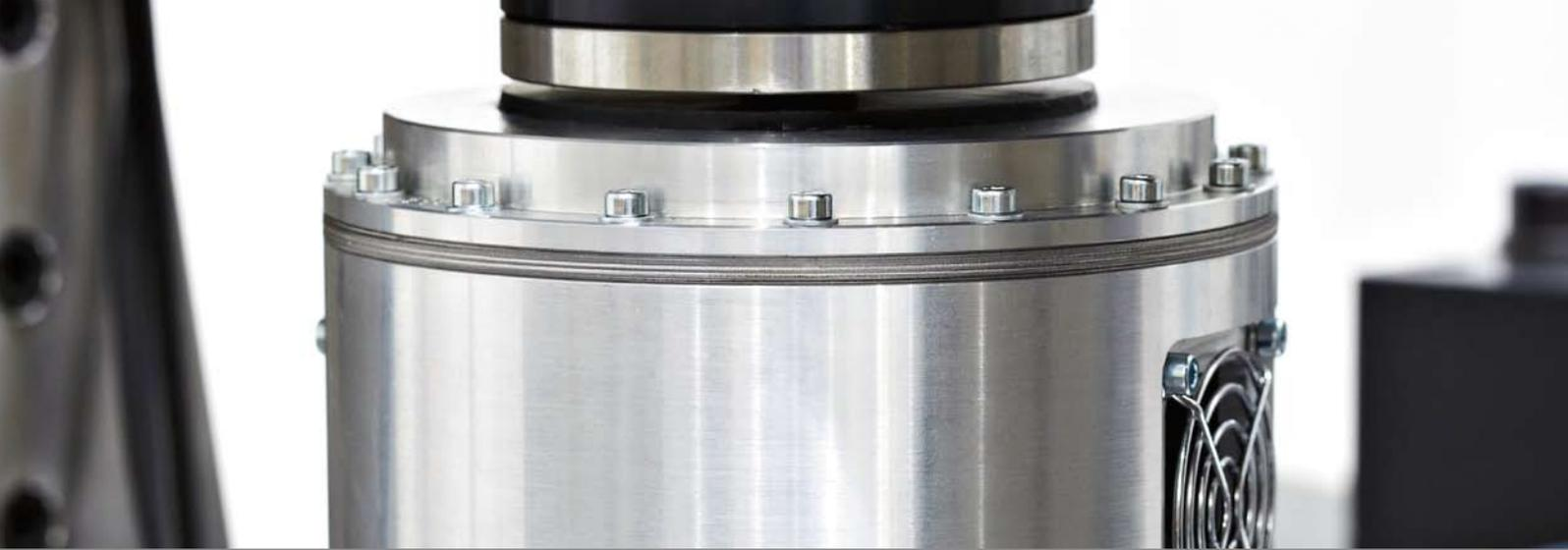
*Aktives Lager zur Entkopplung des Motors von der Karosserie.
