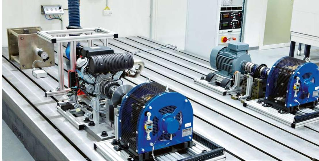
*VaSA - Versuchseinrichtung für aktive Systeme im Antriebsstrang.
