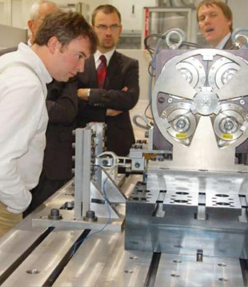
*Prüfstand zur Vermessung von Rotationsschwingungssystemen.
