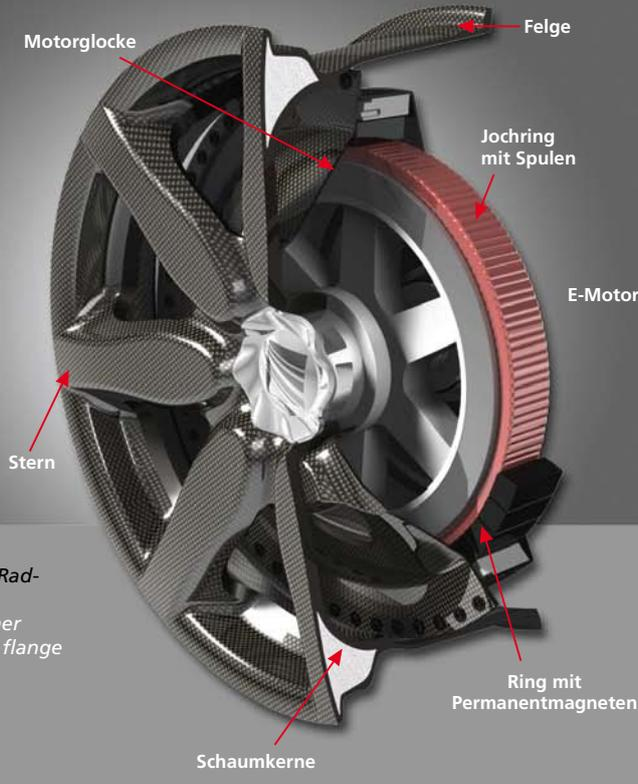
**Kohlenstoffaserverbund (CFK) Rad – Motorglocke und Radnabenmotor – Schnitt.**
