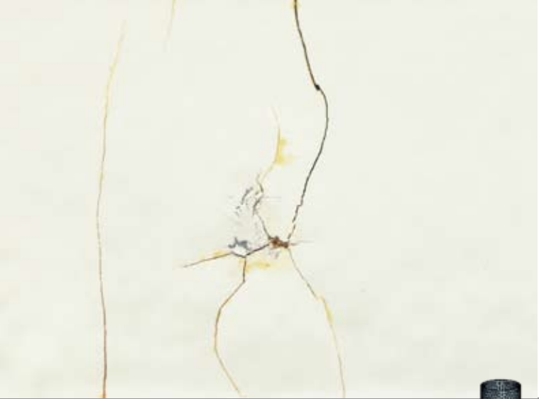
Korrosive Prozesse bei einer lokalen Beschädigung der Korrosionsschutzlackierung. Corrosive process of a local damage in the corrosion protection coating.
