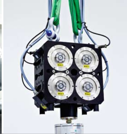
Zwei-axialer Unwulterreger zur Anregung und Testen von aktiven Motorlagern. Bi-axial exciter for loading and testing of active engine mounts.
