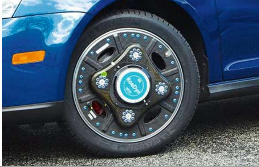
Zur Ermittlung von Lastdaten werden spezielle Messräder eingesetzt. Evaluation of load data with special measuring wheels.
